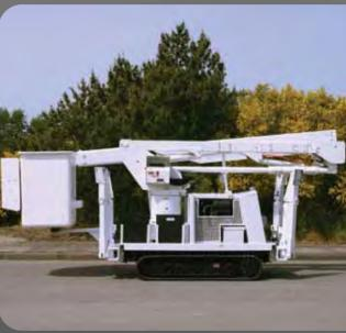
Платформы на гусеничном ходу сконструированы для повышения маневренности и простоты в эксплуатации. Они имеют узкую гусеничную базу, что позволяет им быстро и легко проникать через узкие проезды и проезжать в задние дворы через узкие ворота. Эта узкая гусеничная база позволяет этим установкам пробираться в такие участки, в которые стандартные платформы на грузовых автомобилях не могут, обеспечивая, таким образом, беспрепятственный доступ в недосягаемые зоны.
