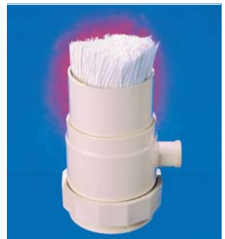
Фильтрующий модуль в разрезе, полые волокна.
