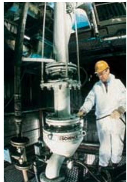
Использование компенсатора типа R-1 фирмы СТЕНФЛЕКС в дозаторе
