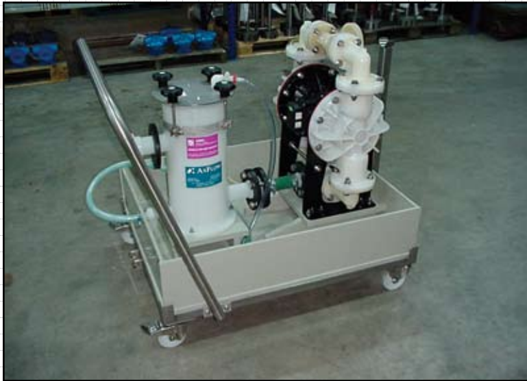
Смонтированный дистрибьютором портативный фильтр на тележке с неметаллическим стандартным насосом.
