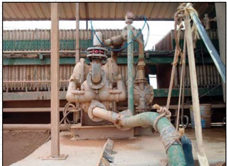
Созданная по заказу клиента высокопроизводительная насосная система фильтр-пресса для сточных вод.
