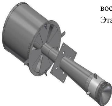
Горелка GreenBurn RW ND - горелка предварительного смешения с естественной тягой, которая использует принцип вентури для воспламенения воздуха, улавливая момент, когда топливо покидает поток. Эта топливно-воздушная смесь покидает сопло горелки через ряд отверстий.
