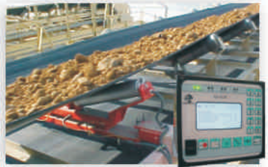
СИСТЕМА НЕПРЕРЫВНОГО ВЗВЕШИВАНИЯ / ВСТРОЕННАЯ В КОНВЕЕР CONTINUOUS WEIGHING/INTEGRATED ON BELT
