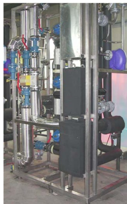
Компактный модуль для обогрева и охлаждения реактора
